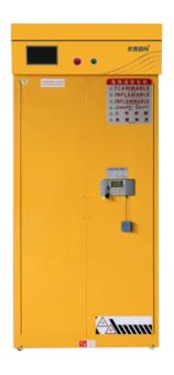
无管道通风柜又叫净气型通风柜、自净化型通风柜等。无管道净气型通风柜主要是指在通风柜上配置有自净化过滤系统装置的通风柜,通过顶部的自净化吸附过滤装置吸附、过滤,实验过程中产生的有毒有害的挥发性气体,以此来保证操作人员的身体健康。净气型通风柜的优点: 1、净气型通风柜不需要连接管道相对于需要建造管道工程的外排型通风柜省钱省力。2、净气型通风柜不会将空调新风直接排除室外,更加节能。3、净气型通风柜适用于很多场所,如老旧无法进行管道工程的实验楼就可选用净气型通风柜。4、净气型通风柜没有管道的限制同时配有可移动底座可以推移而不受影响。
